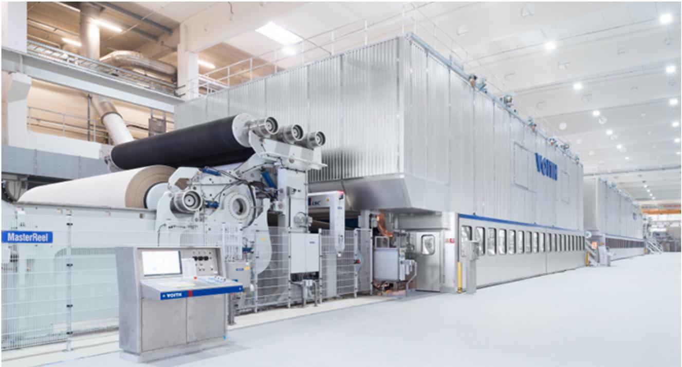
27.02.2017 - Bei Schoellershammer in Düren ist im vergangenen Dezember die neue Verpackungspapiermaschine PM 6 in Betrieb gegangen. Sie ist ausgelegt für die Herstellung leichter Wellpappenrohpa-piere. Voith lieferte die Papiermaschine einschließlich der Stoffaufbereitung, der Maschinensteuerung und der Bespannung. Auf der Anlage konnte Schoellershammer schon im Januar 10.000 Tonnen verkaufsfähiges Papier herstellen.
